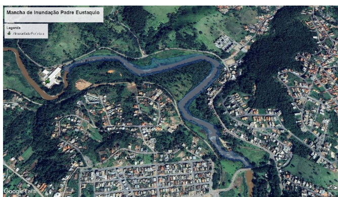
Figura 3. Mancha de inundação do Rio Itabirito no bairro Padre Eustáquio, atingindo terrenos nos fundos de algumas residências.
