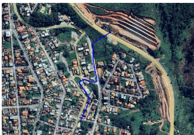
Figura 19. Trajeto da enxurrada no bairro Novo Santa Efigênia. O volume de água é canalizado da BR-356 para a Av. dos Inconfidentes, causando transtornos no bairro.
