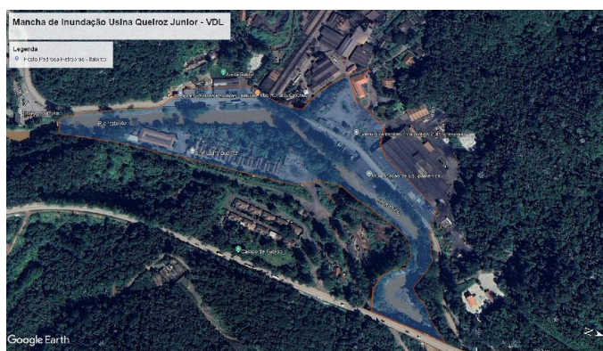
Figura 9. Mancha de inundação do Rio Itabirito na Siderúrgica Itabirito Ltda (Antiga VDL Siderurgia).
